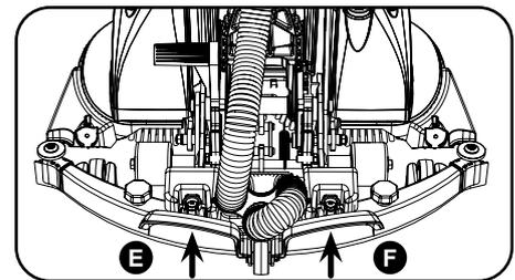
Pour abaisser le suceur, appuyez sur le levier de la pédale de gauche à l'arrière de la machine (10-A).
